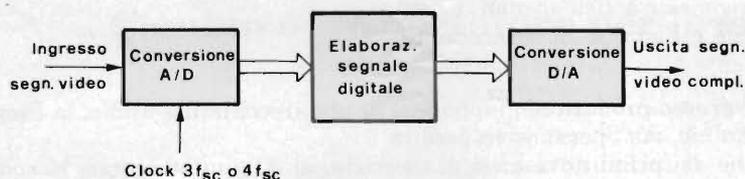
Fig. 1 - Codifica PCM composta del segnale video a colori completo.
