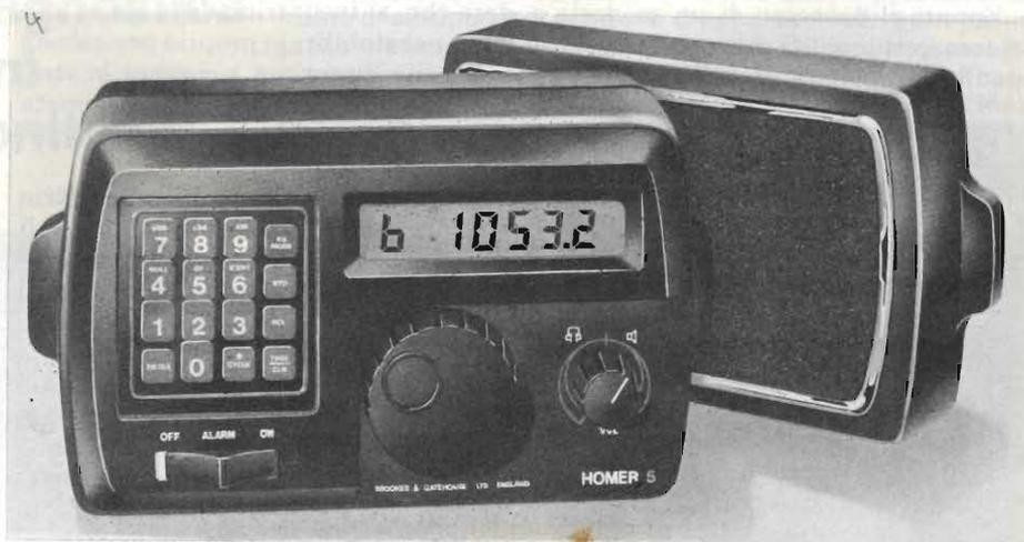
Fig. 4 - Uno fra i più completi radioricevitori per la ricezione della gamma  $50$  kHz  $\div$   $25$  MHz a salti di  $0,1$  kHz, doppia conversione di frequenza, memorizzazione di frequenze e dispositivi di allarme. Si tratta del modello HOMER 5.
